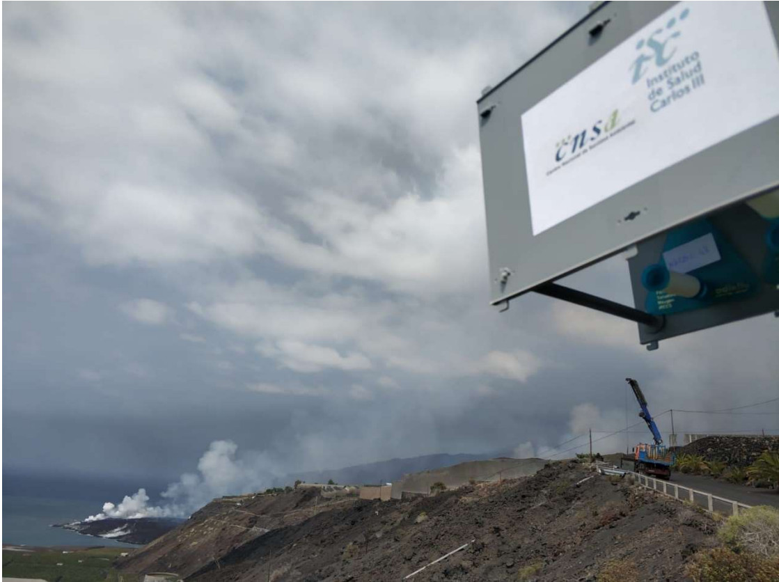
Captador de ácido clorhídrico, una de las sustancias que se están analizando, instalado en las inmediaciones de la plataforma marina formada por los depósitos de lava por el equipo del CNSA-ISCI III que se ha desplazado a la isla de La Palma.
