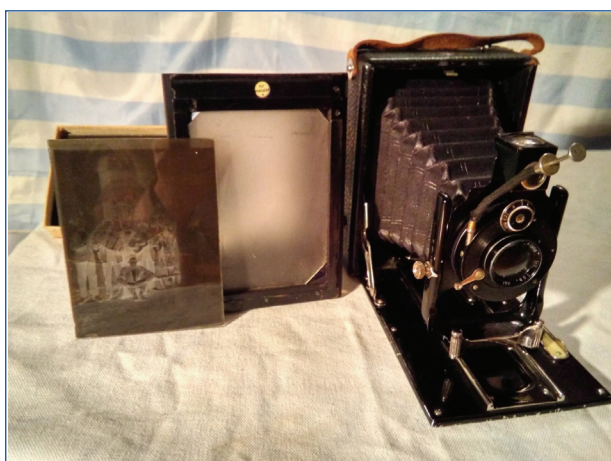
Figura 9. Cámara de fuelle ICA PERISKOPE ALPHA Ges (Dresden) de 1920 y placas al gelatino-bromuro de plata, virgen dentro del chasis y procesada.
