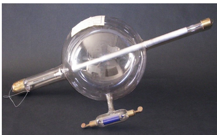
Imagen 1. Tubo de Crookes o de cátodo frío fabricado entre 1905 y 1925 (1)
