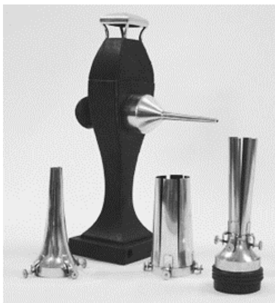
Imagen 26. Conductor lumínico de Bozzini original con espejos (41)
