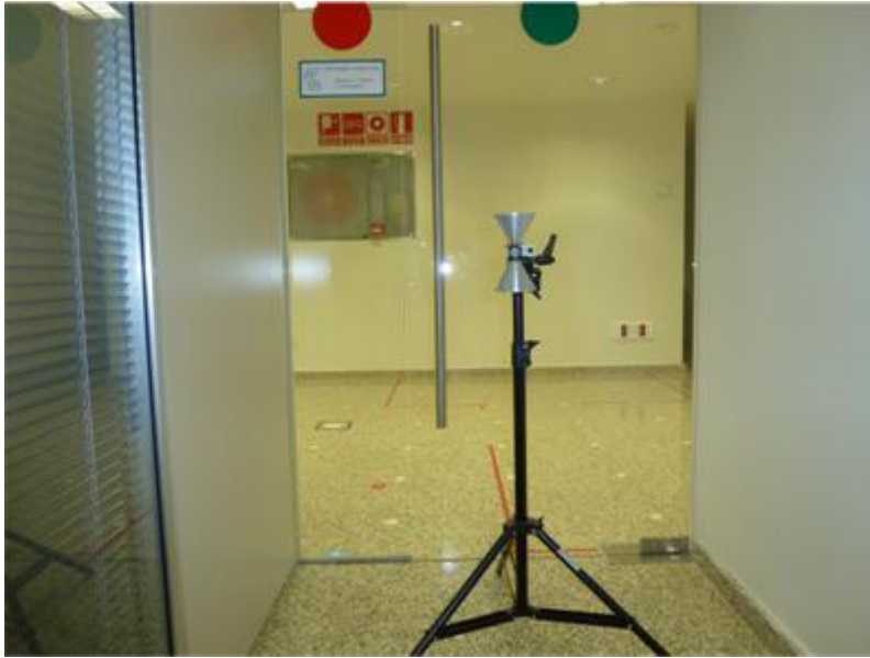
Figura 30. Posición de la antena durante la realización del experimento en polarización vertical
